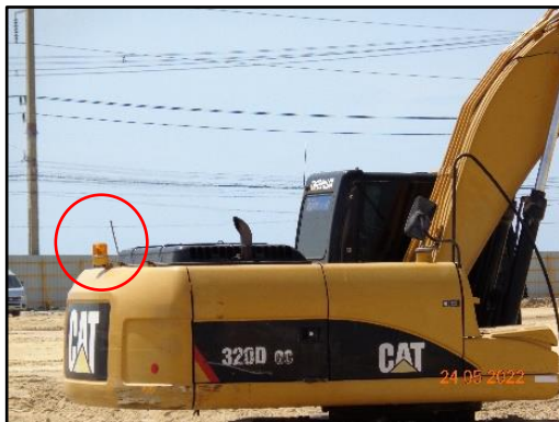
รูปที่ 2-59 ไฟสัญญาณที่ท้ายเครื่องจักร
