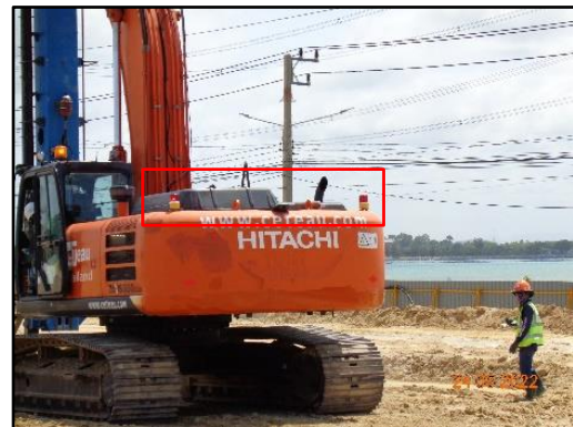
รูปที่ 2-59 ไฟสัญญาณที่ท้ายเครื่องจักร
